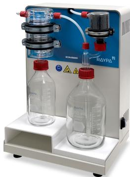
Газы, образующиеся при сбраживании, остаются в установке после конденсации и абсорбции. Идеально подходит для использования в сочетании с системой разложения Compact MBC. Преимущества Встроенный вакуумный насос от 48 л / мин от 10 мбар до 800 мбар. Экономия охлаждающей воды в варочных блоках. Это закрытая система дымоудаления. Фильтрация и нейтрализация вредных паров.
