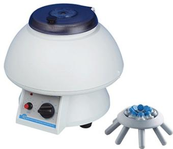
Применение: разделение раствора внутри центрифугируемой пробирки за счет центробежного ускорения, создаваемого при вращении пластикового сменного ротора. По окончании процесса происходит образование осадка внутри сосуда и растворителя сверху. Дизайн современный, красивый внешний вид и долговечный.
