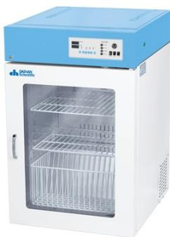
Холодильники фармацевтические предназначены для хранения образцов при температуре в рабочей камере от 2 до +10 °С. Полиуретановая изоляция высокой плотности (толщиной 60 мм) обеспечивает отличную стабильность температуры. Управление прибором осуществляется с помощью микропроцессора
