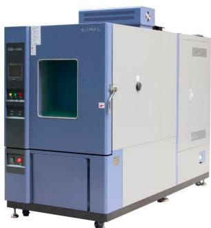
Камеры быстрого изменения температуры - это очень мощные климатические камеры, используемые для проведения циклов нагрева и охлаждения с резкими температурными градиентами (от 3 до 15°C/мин в зависимости от температурных диапазонов) Камеры широко применяются для испытаний на адаптивность к температуре в условиях быстрого изменения или градиента для электрических, электронных, приборов и других продуктов или запасных частей, в частности, используется в испытаниях на стресс окружающей среды (ESS®)
