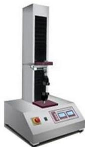
Универсальная испытательная машина - универсальное оборудование для проведения испытаний физических свойств. Они способны измерять нагрузку, прочность, удлинение продуктов или материалов, таких как резина, пленка, пластик, металл и т. д.
