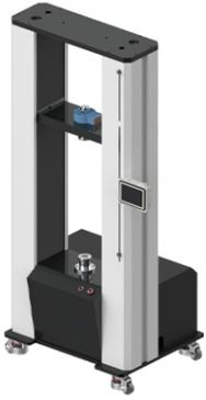
Универсальная испытательная машина - универсальное оборудование для проведения испытаний физических свойств. Они способны измерять нагрузку, прочность, удлинение продуктов или материалов, таких как резина, пленка, пластик, металл и т. д.
