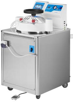
Серия средоварок AE-MP предназначена для подготовки, стерилизации и дозирования высококачественных питательных сред с превосходной воспроизводимостью от партии к партии. Благодаря эффективной системе нагрева и быстрому охлаждению сокращают время полного цикла приготовления среды. Безопасность Система блокировки дверей с датчиком положительного давления. Датчик открытия двери. Детектор уровня воды. Клапан безопасности. Термостат безопасности.
