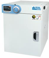
Инкубатор "ThermoStable SIF" с принудительной конвекцией воздуха. Изготавливаются в стальном корпусе с защищенным порошковым покрытием, внешней блокируемой и внутренней дверью из закалённого стекла. Трехсторонний механизм нагрева, обеспечивает равномерность и точность благодаря высокой производительности. Применяется в культивировании клеток животных и растений, хранение микроорганизмов, проращивание и т.д.
