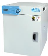
Инкубатор "ThermoStable IG" с естественной конвекцией. Изготавливаются в стальном корпусе с защищенным порошковым покрытием, внешней блокируемой и внутренней дверью из закалённого стекла. Трёхсторонний механизм нагрева, обеспечивает равномерность и точность благодаря высокой производительности. Применяется в культивировании клеток животных и растений, хранение микроорганизмов, проращивание и т.д.
