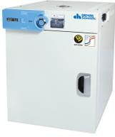
Сухожаровой стерилизатор серии SteD с принудительной конвекцией воздуха. Корпус выполнен из стали с порошковым покрытием, камера из нержавеющей стали. Трехсторонний механизм нагрева, обеспечивает равномерность и точность благодаря высокой производительности. Оснащены цифровой системой управления ПИД-регулятором, обеспечивая высокую точность температуры. Подходит для клинической стоматологии, медицины, биотехнологии и т. д.
