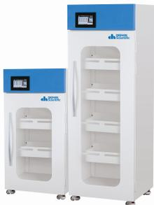
Фильтрующий шкаф от DAIHAN для хранения химических реактивов полностью полипропиленовый/поливинилхлоридный, камера из полипропилена с гибридным композитным фильтром, прозрачное окно из ПВХ. Полностью закрытая самоциркулирующая система, которая предотвращает попадание воздуха внутри шкафа в помещение и пары реагентов фильтруются через 4-слойный гибридный композитный фильтр. Идеально подходит для хранения кислотно-химических летучих органических соединений.
