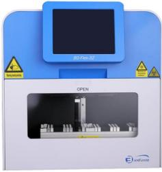
Система BG-Flex-32 предназначена для очистки нуклеиновых кислот. Принцип работы основан на технологии магнитной адсорбции. Магнитная частица специфически адсорбирует молекулы-мишени, такие как нуклеиновые кислоты или белки, в образце, а затем адсорбирует и переносит частицу посредством перемещения магнитного стержня в разные лунки для достижения очистки молекул-мишеней. Процесс полностью автоматизирован и без ручного управления.
