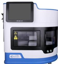
Система BG-Abot-96 предназначена для очистки нуклеиновых кислот. Принцип работы основан на технологии магнитной адсорбции. Магнитная частица специфически адсорбирует молекулы-мишени, такие как нуклеиновые кислоты или белки, в образце, а затем адсорбирует и переносит частицу посредством перемещения магнитного стержня в разные лунки для достижения очистки молекул-мишеней. Процесс полностью автоматизирован и без ручного управления.
