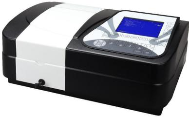
Спектрофотометр серии UV-VIS применяется для научных исследований контроля качества в химической, биохимической и медицинской промышленности, а также на производстве экологии и охраны окружающей среды, и т. д. Основной блок и программное обеспечение могут независимо реализовывать функции количественного анализа, кинетики, сканирования длины волны, многоволнового анализа, анализа ДНК/белка и печати данных с обработкой данных.
