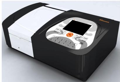
Спектрофотометр серии UV-VIS применяется для научных исследований контроля качества в химической, биохимической и медицинской промышленности, а также на производстве экологии и охраны окружающей среды, и т. д. Основной блок и программное обеспечение могут независимо реализовывать функции количественного анализа, кинетики, сканирования длины волны, многоволнового анализа, анализа ДНК/белка и печати данных с обработкой данных.
