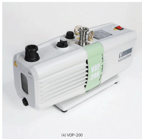
Вакуумные насосы серии VOP предназначены для применения в системах испарения, вакуумной сушки, лиофильной сушки и пр. Вакуумные насосы серии VOP – двухступенчатые, со встроенным газобалластным клапаном и фильтром. Максимальный вакуум – 0,067 Па. Производительность мотора – 1430 оборотов/мин.
