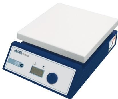
Магнитные мешалки с подогревом серии MSH-D предназначены для перемешивания и нагрева жидкостей объемом до 20 литров. Максимальная регулируемая температура нагрева – 380 °С. Регулирование температуры производится с высокой точностью - погрешность регулирования температуры не более  $\pm 0,3$  °С. Цифровой контроль с обратной связью и регулирование параметров работы с помощью встроенной панели управления.
