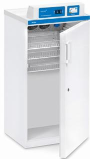
Анализ воды, определение БПК (биологической потребности в кислороде), ферментативные анализы, низкотемпературные культуры клеток и бактерий, ботаника, сохранение образцов, старение и косметика. Комплектация: · 3 съемных поддона из нержавеющей стали с пластиковым покрытием (4 поддона для модели IRE-475). · Доступ к онлайн-платформе RAYPAnet.
