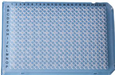
Данная серия имеет 96 и 384 луночные пластины в плинтусных и не плинтусных планшетах. Предназначен для внесения в его лунки различных реагентов для последующего термостатирования, микроскопирования и проведения исследования культур клеток, в частности, совместимости трансплантов донора и реципиента. Имеется буквенно-цифровая маркировка, максимально облегчающая организацию анализа. Без крышки.
