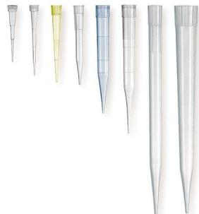
Наконечники для дозаторов предназначены для дозирования, разделения и перемешивания различных жидкостей и веществ, в том числе и в небольших объемах. Это один из самых востребованных расходных материалов, применяющийся в клинических и исследовательских лабораториях, лечебных учреждениях и т. д. Наконечники без фильтра идеально подходят для молекулярно-биологических исследований.
