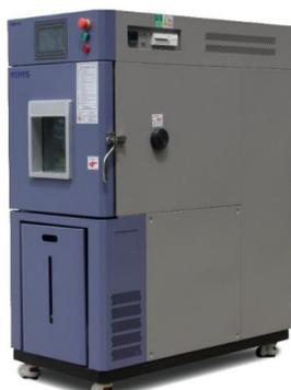
Испытательные климатические камеры позволяют имитировать агрессивное воздействие окружающей среды: высокие или низкие температуры воздуха, уровень влажности. Устройства этого типа обеспечивают во внутреннем объеме длительное поддержание температуры в диапазоне от 20 до 100 градусов Цельсия и уровень влажности от естественного до 98%. Основное назначение этих приборов – испытания различных материалов и изделий в статичном режиме.
