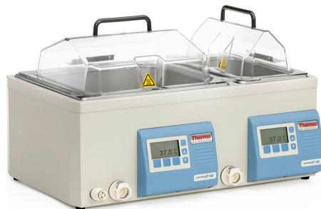
Водяные лабораторные бани общего назначения серии Precision применяются в рутинных исследования для нагревания, охлаждения, выпаривания, кристаллизации, экстракции, инкубирования, термостатирования, для работы с биологическими образцами и для многих других целей. Бани серии Precision обеспечивают равномерный нагрев и контроль температуры с высокой точностью.
