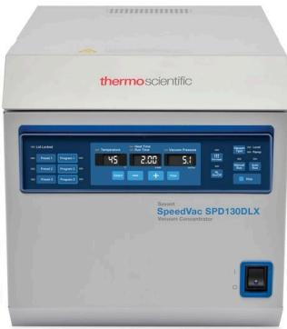
Thermo Scientific Savant SpeedVac SPD130DLX — вакуумный концентратор средней емкости с модульной конструкцией. Он совместим с большим количеством растворителей и обладает сопротивляемостью к трифтормукусной кислоте, ДМСО и другим агрессивным растворителям, которые применяются в комбинаторной химии.
