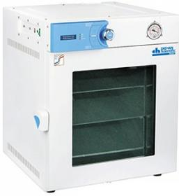
Вакуумные сушильные шкафы модели ThermoStable OV с цифровым ПИД-регулированием, включают два независимых воздушных канала: вентиляционную линию и линию вакуума, которые имеют отдельные внешние порты. Эта структура оптимизирует обмен газа в камере. Подходит для сушки, выпечки, кондиционирования, отверждения, выделения газов из твердых и жидких веществ.
