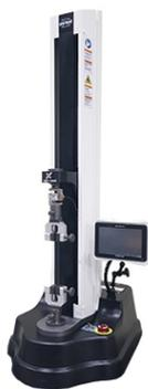
Универсальная испытательная машина - универсальное оборудование для проведения испытаний физических свойств. Они способны измерять нагрузку, прочность, удлинение продуктов или материалов, таких как резина, пленка, пластик, металл и т. д.
