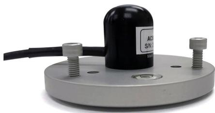
Apogee Sunlight Quantum Sensor датчик для точного измерения PAR (Photosynthetically Active Radiation/фотосинтетически активное излучение) в условиях солнечного света. Датчик специально откалиброван для использования в условиях солнечного света. Корпус датчика оборудован полностью герметичной куполообразной головкой, что делает датчик полностью погодоустойчивым и самоочищающимся.
