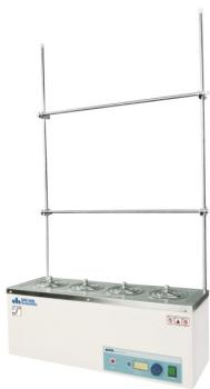
Бани водяные экстракционные серии WEB предназначены для стандартных лабораторных исследований, таких как классическая экстракция, экстракция по методу Сокслета, измерение химического потребления кислорода и пр. Концентрические крышки мест для сосудов позволяют устанавливать лабораторную посуду необходимого диаметра. В комплект поставки бани входит штатив для безопасного устойчивого размещения лабораторных приборов и сосудов.
