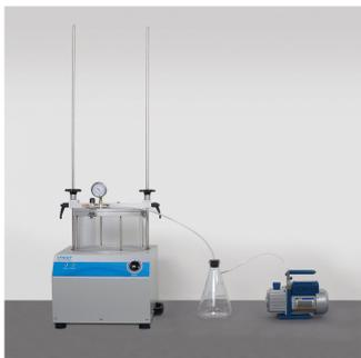
Вакуумные пикнометры используются для определения теоретического максимального удельного веса и плотности уплотненных или неуплотненных битумных смесей для укладки (пустотная масса). Процент воздушных пустот в уплотненных битумных смесях и количество битума, поглощенного заполнителями, также могут быть рассчитаны с помощью этого теста.
