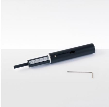
Карманный пенетрометр предназначен для быстрого определения консистенции грунта и оценки прочности на сжатие при свободном боковом расширении связных грунтов. Карманный пенетрометр используется при полевых исследованиях и сравнении аналогичных типов почвы.
